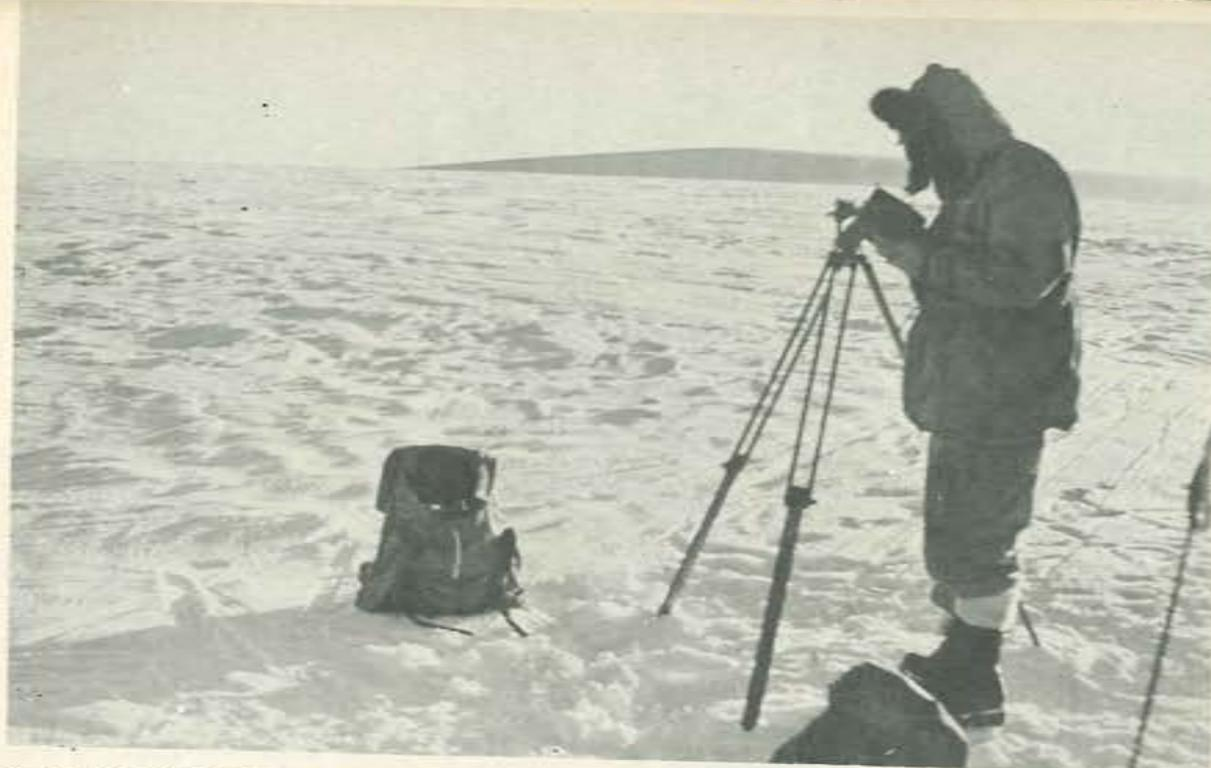
La red de estacas nivométricas es controlada con niveles de precisión.
