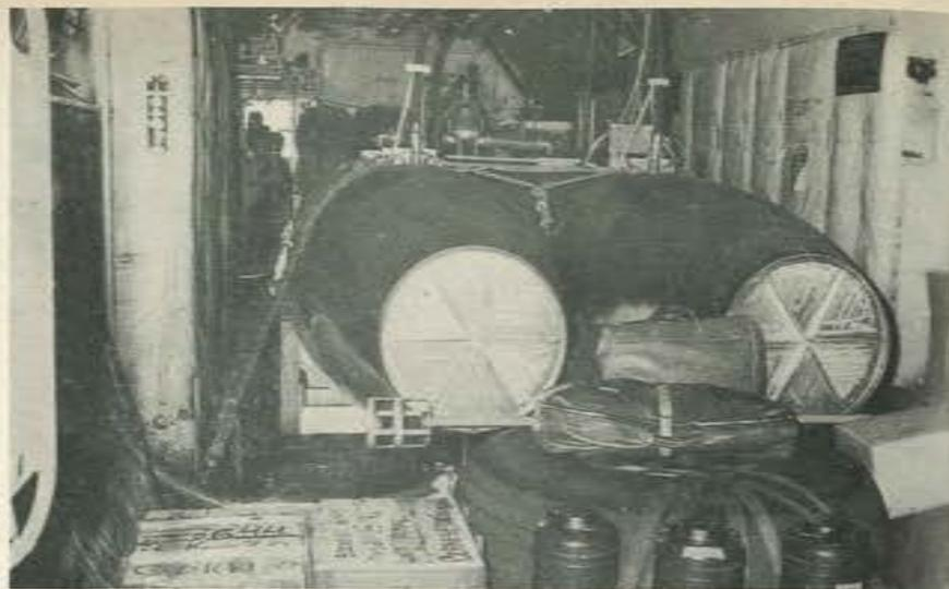
Aspecto del interior del Hércules con los dos tanques de combustible adicionales.
