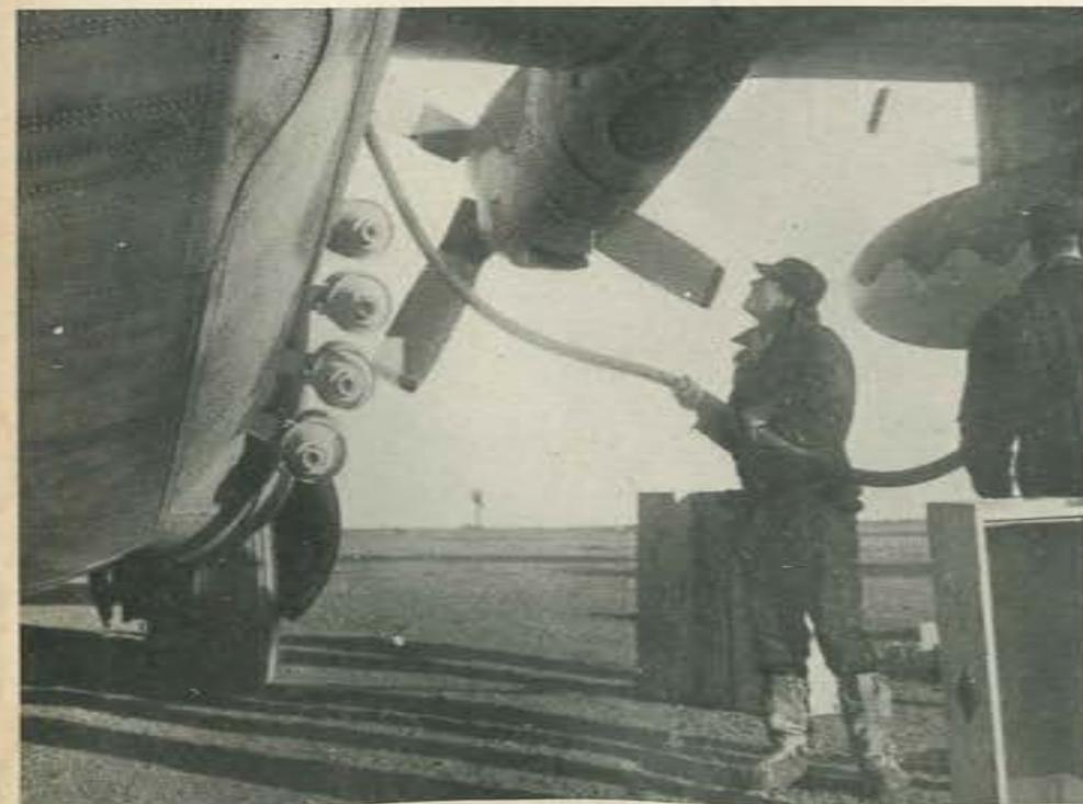
En la base antártica Vicecomodoro Marambio se procedió a reabastecer de combustible al aparato y otorgarle así la autonomía necesaria para cumplir el salto hasta Australia. El costado del avión muestra a los "jatos" ya instalados.
