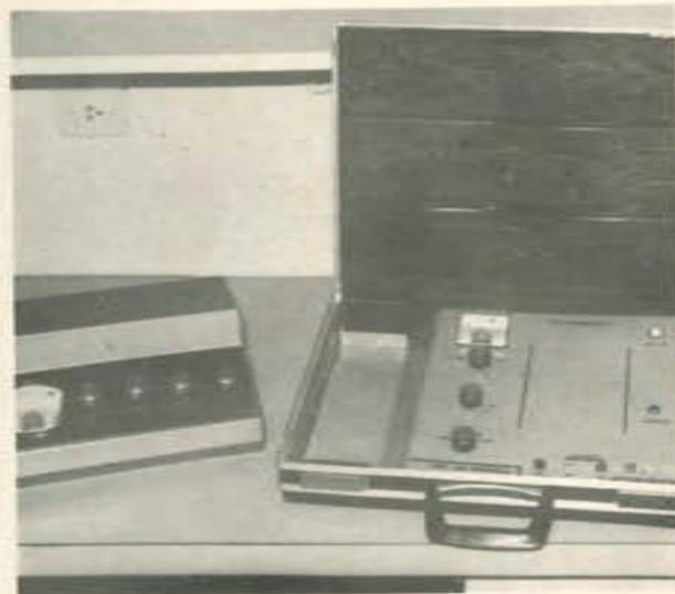
Parte del equipo utilizado en transmisión y recepción de trazados electrocardiográficos.
